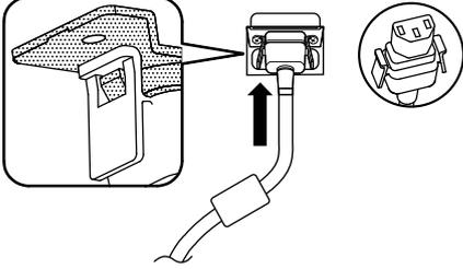
**Schließen Sie das Netzkabel an die Displayeinheit an.**
