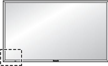
**Capteur infrarouge de l'écran tactile**
