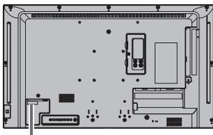
Introduza o cabo CA de forma segura na parte traseira do aparelho.
