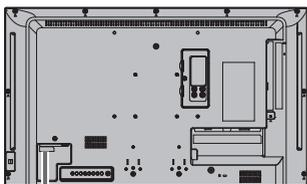
Вставьте кабель питания до упора в разъем на тыльной стороне устройства.
