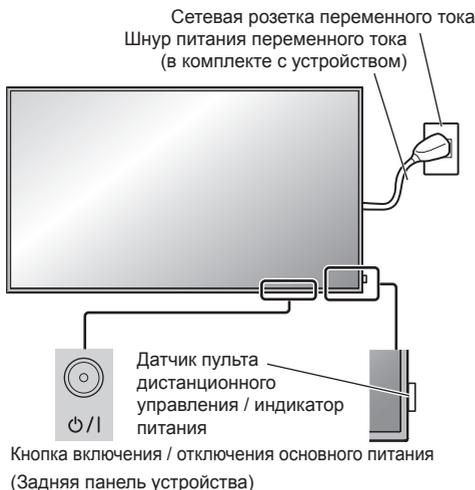
При работе направляйте пульт дистанционного управления непосредственно на датчик пульта дистанционного управления устройства.
