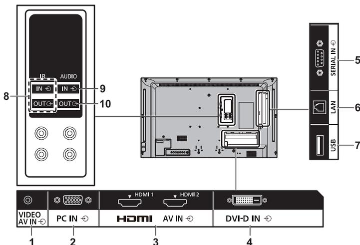
**1 AV IN (VIDEO): Композитный аудио/видео разъем**
