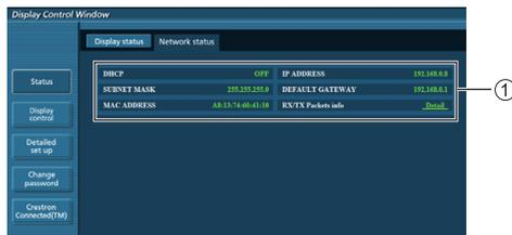
① Visualizza i dettagli relativi alla configurazione della LAN cablata.
