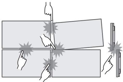
Una volta fissati i display alle staffe sul retro e regolate le posizioni, non regolare le posizioni sulle parti anteriori usando la piastra, ecc.
