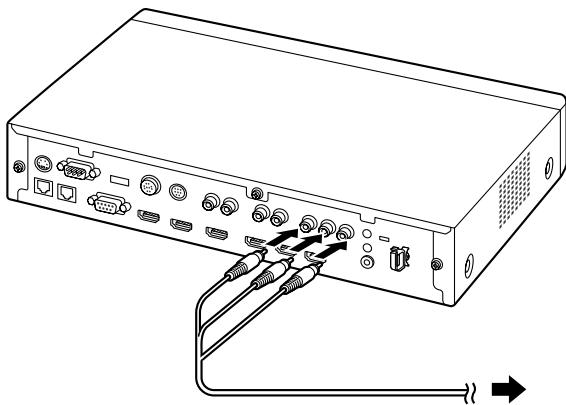
1. 使用分量电缆将显示器连接到本机背面的component端子上。
