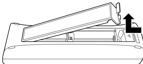
2. 插入电池（R6 [AA]干电池）时先插入负极，然后将盖关闭。
