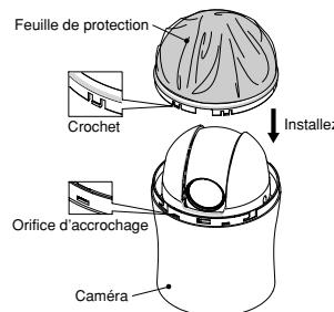
**3** Installation de la bague de fixation du dôme.
