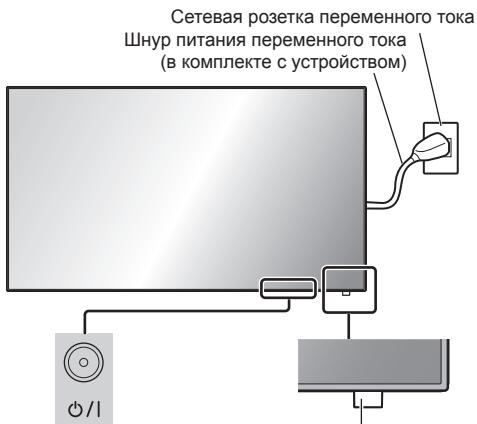
Кнопка включения / отключения основного питания
