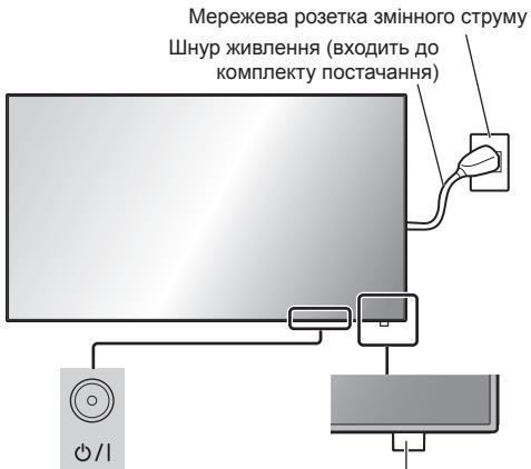
Кнопка включення/виключення основного живлення (задня панель пристроя)
