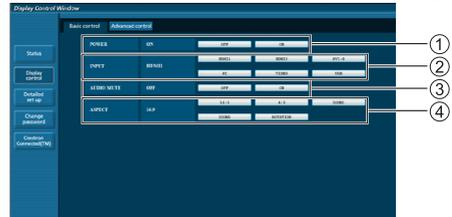
① Control de encendido y apagado
