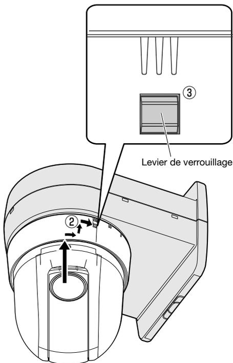
③ S'assurer que le levier de verrouillage est solidement inséré dans le trou du couvercle décoratif (la partie inférieure).
