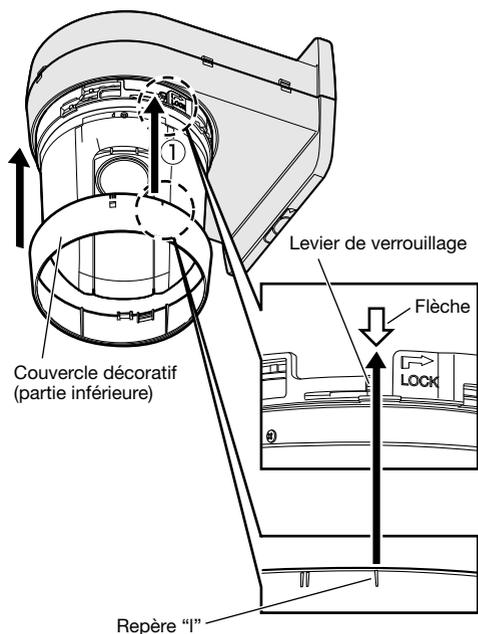
② Faire pivoter le couvercle décoratif (inférieur) dans le sens des aiguilles d'une montre lorsqu'il est observé par en-dessous sur approximativement 16 degrés pour l'insérer vers le haut.
