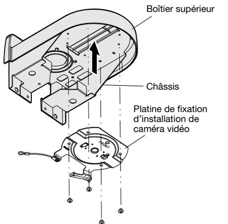
Vis de fixation (M4 x L4, servant à la fixation de la platine de fixation d'installation de caméra vidéo fournie avec la caméra vidéo)
