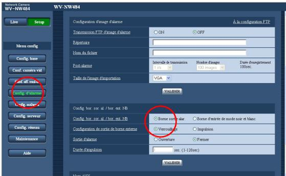
Il est possible d'émettre des signaux à partir de la borne de sortie d'alarme et de faire retentir l'avertisseur sonore en cas d'alarme.
