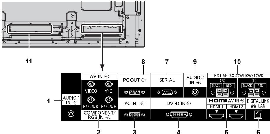
**1 AUDIO 1 IN :** Uzlazni audio terminal dijeljen s terminalima COMPONENT/RGB IN i VIDEO IN
