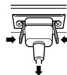
Iskopčajte AC kabel pritiskom na dvije tipke.
