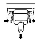
Iskopčajte AC kabel pritiskom na dvije tipke.
