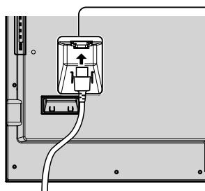
**Pričvršćivanje AC kabela**
