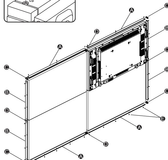
組み付けた際にパネルとカバーフレームの間に隙間が生じますが、不具合ではございません。
