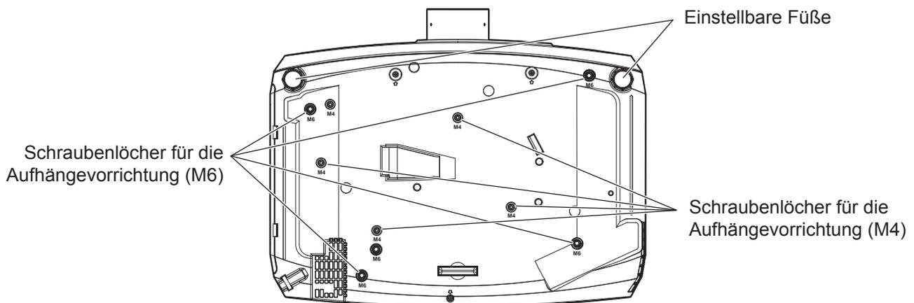
Die Positionen der Schraubenlöcher für die Aufhängevorrichtung und die einstellbaren Füße
