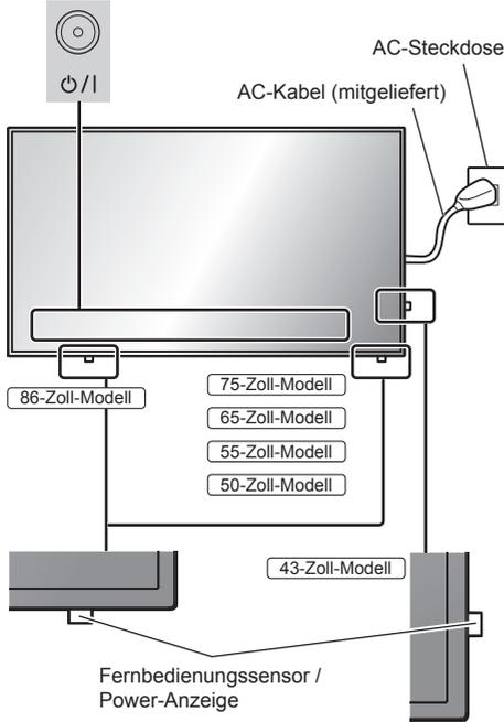
Richten Sie die Fernbedienung bei der Bedienung direkt auf den Fernbedienungssensor des Geräts.
