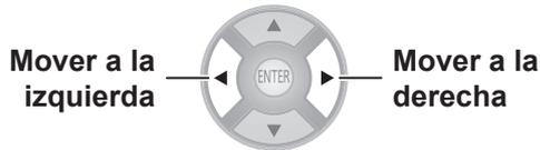
Por ejemplo, al proyectar un área de proyección de 16:9 con overscan con una relación de aspecto 4:3 en una pantalla de aspecto 4:3, puede ajustar la discrepancia horizontal entre la posición de la pantalla y la posición de la visualización de vídeo.
