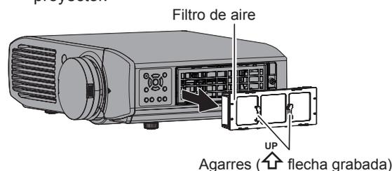
\* Después de retirar el filtro de aire, retire cualquier acumulación de suciedad o polvo del compartimiento del filtro de aire y del orificio de entrada de aire del proyector.
