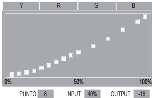
2. Pulse el botón <RETURN> para volver a la pantalla que aparece en 4), y a continuación seleccione [AJUSTES DE GAMMA] mediante los botones ▲▼.
