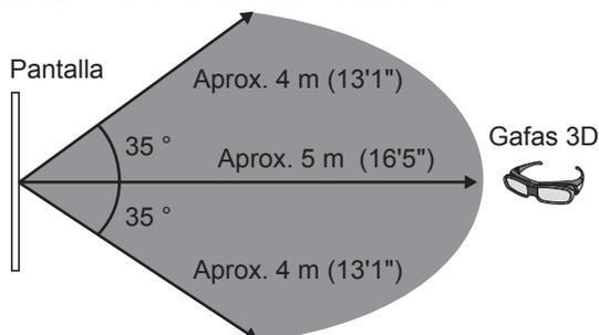
El diagrama anterior muestra el rango de comunicación bajo las siguientes condiciones:
