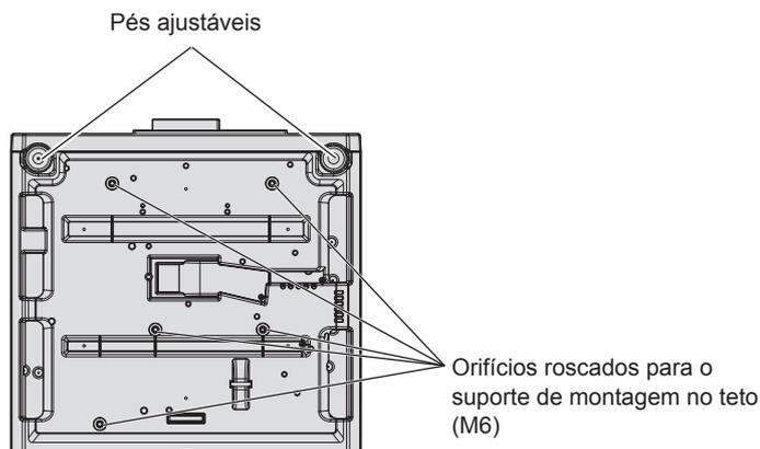
Posições dos orifícios roscados para o suporte de montagem no teto e pés ajustáveis
