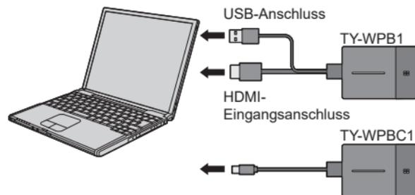
Verbinden Sie für den USB-C-Sender den USB-Anschluss (Type-C) mit dem Bildausgabegerät.
