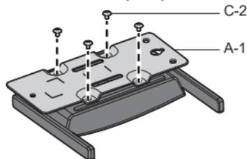
Die Basishalterung kann entweder vertikal oder horizontal angebracht werden.
