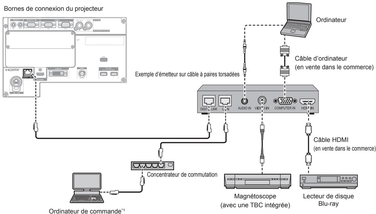
\*1 La cible de contrôle est le projecteur ou l'émetteur sur câble à paires torsadées. Le contrôle lui-même risque d'être impossible selon l'émetteur sur câble à paires torsadées. Vérifiez le manuel d'utilisation du périphérique à raccorder.
