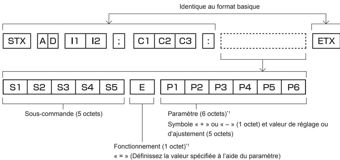
\*1 Lorsqu'une commande ne nécessitant pas de paramètre est transmise, aucune opération (E) et aucun paramètre ne sont nécessaires.
