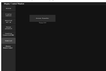
**3 Нажмите [Screen Transfer] для загрузки программы установки “setup.msi”.**
