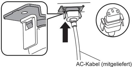
Setzen Sie den Stecker in das Anzeigergerät ein.
