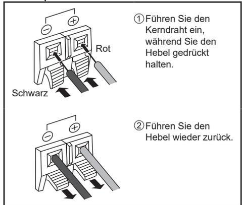
① Führen Sie den Kerndraht ein, während Sie den Hebel gedrückt halten.
