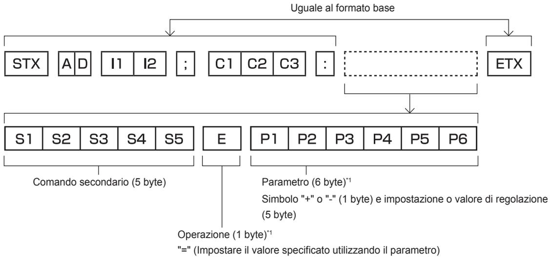
\*1 Quando si trasmette un comando che non ha bisogno di un parametro, l'operatore (E) e il parametro non sono necessari.
