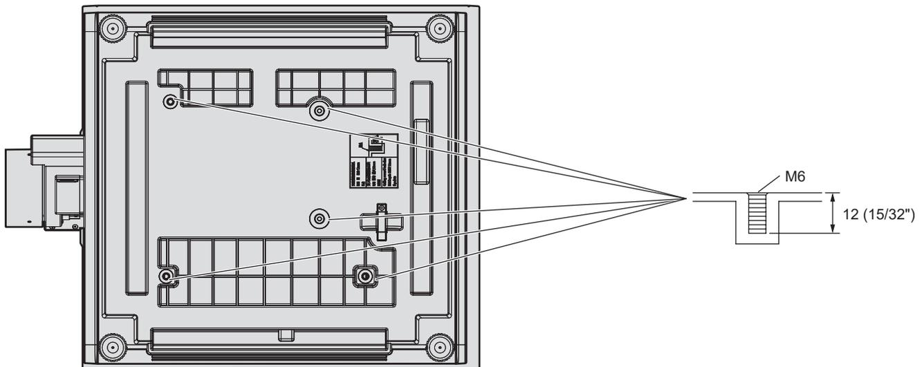
■ Dimensiones para los orificios roscados para fijar el proyector (vista inferior del proyector)
