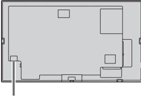
Fijación del cable de alimentación
