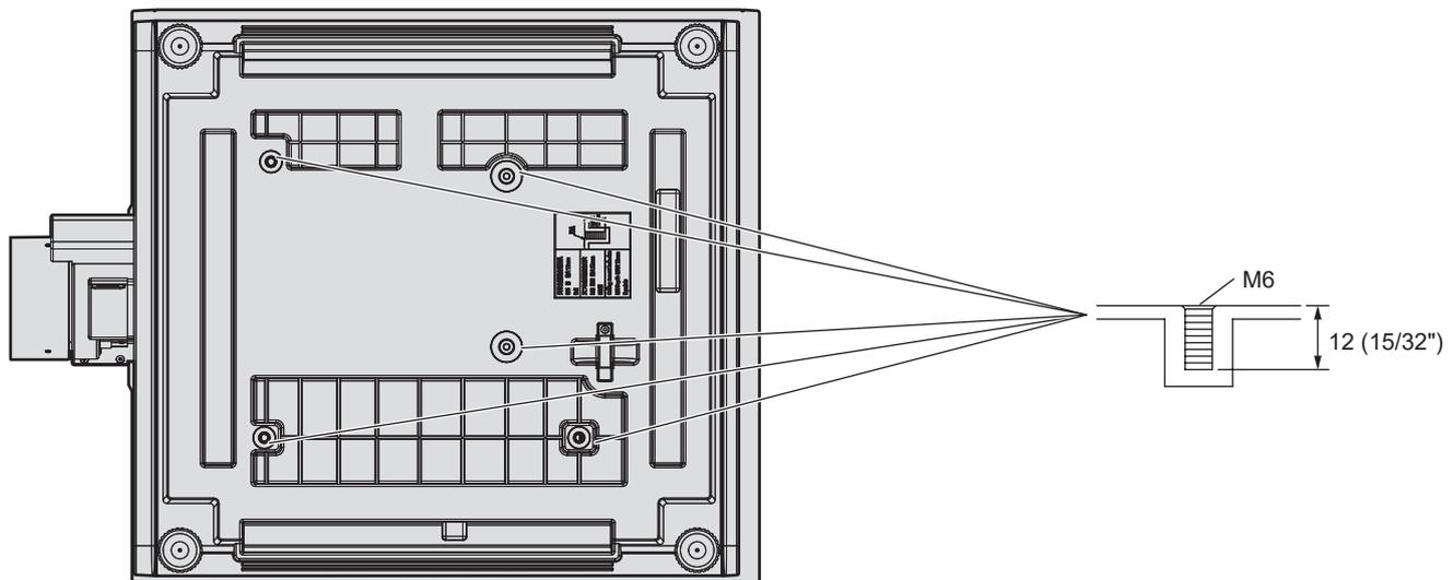
■ Dimensioni per i fori per le viti per fissare il proiettore (proiettore visto dal basso)
