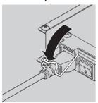
4 Pressione o suporte do fio da alimentação até que a extremidade do suporte encaixe no fio da alimentação, para que este figue fixado.
