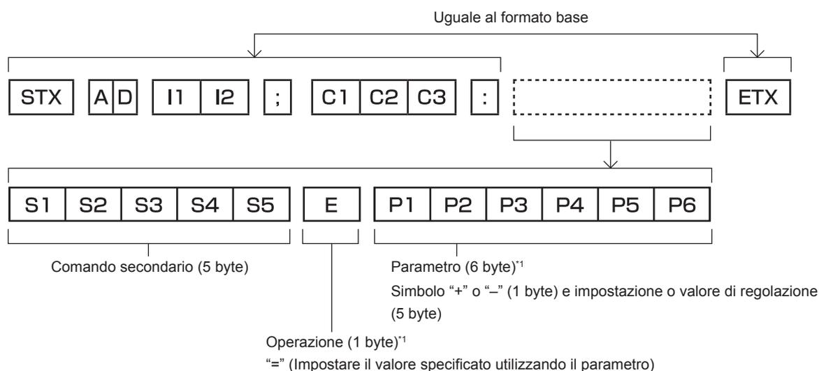
\*1 Quando si trasmette un comando che non ha bisogno di un parametro, l'operatore (E) e il parametro non sono necessari.
