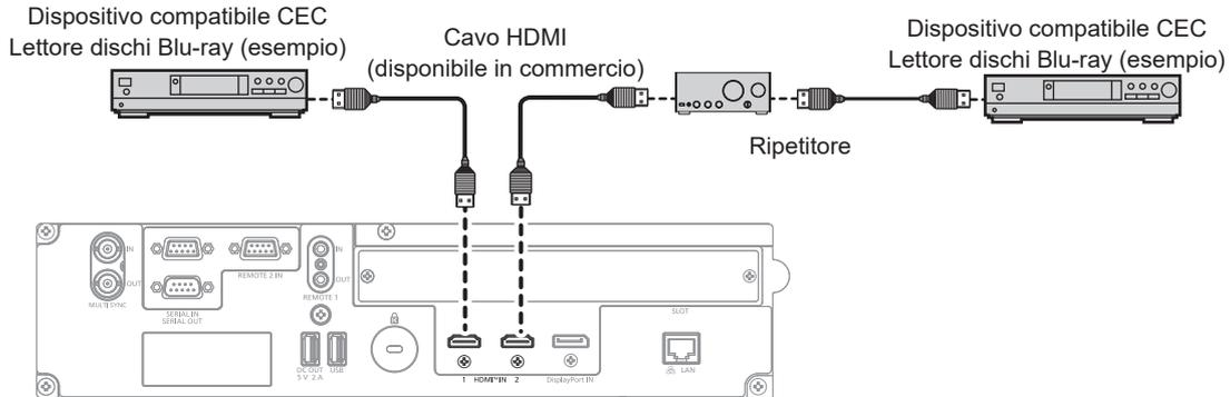
Esempio di connessione con dispositivo compatibile CEC
