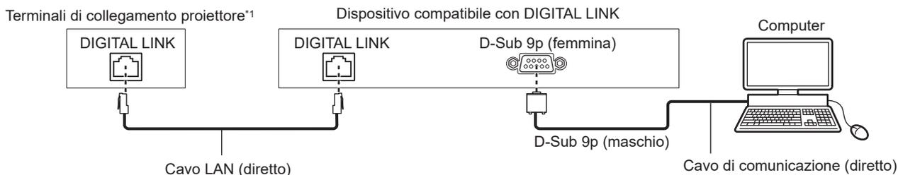
\*1 Quando la Scheda terminale DIGITAL LINK opzionale (Modello n.: TY-SB01DL) è installata nello slot
