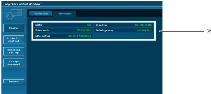
\* Muestra los detalles de configuración de la red LAN cableada.
