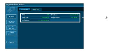
\* Visualizza ulteriori informazioni sulla configurazione della LAN cablata.
