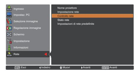
Premere il tasto <ENTER> o il tasto ▶ per accedere al sottomenu. Selezionare le voci [Controllo WEB], [Controllo PJLink], [Controllo comando], [AMX D.D.] con i tasti ▲▼.
