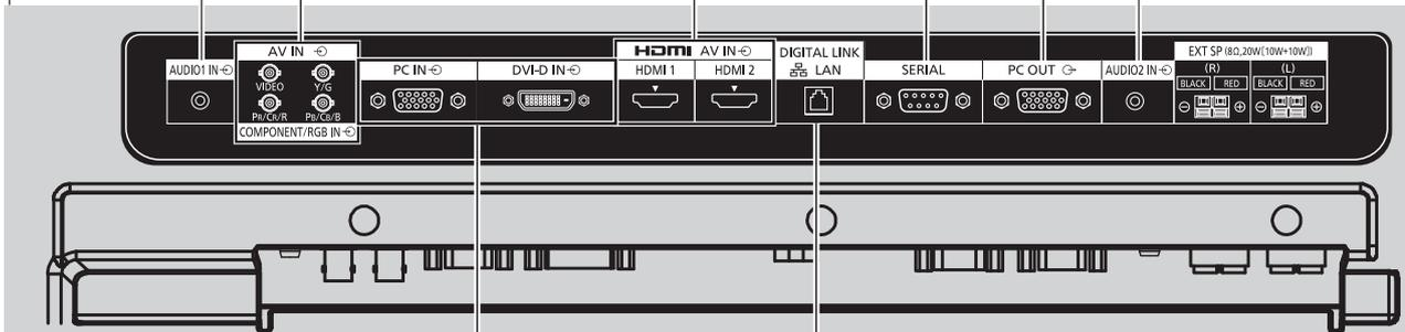
**PC IN:** Terminal de entrada de PC Conecte al terminal de vídeo del PC o equipo con la salida Y, P<sub>B</sub>(C<sub>B</sub>) y P<sub>R</sub>(C<sub>R</sub>) (vea la página 14).
