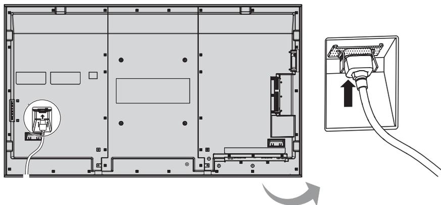
Conexión de la clavija a una toma de corriente
