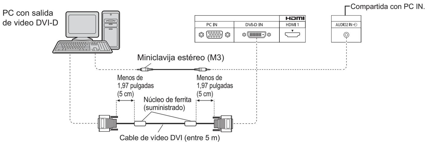
**Instalación del núcleo de ferrita**
