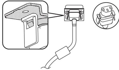
**Conecte el cable de CA a la unidad de pantalla.** Al conectar el cable de CA, presione hasta que suene click.
