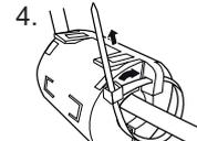
4. Den Ferritkern mit dem Kabelbinder befestigen
