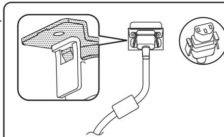
**Schließen Sie das Netzkabel an die Displayeinheit an.**
