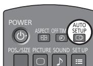
Wenn Sie auf der Fernbedienung
