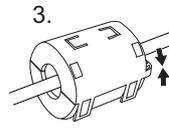
3. Kabel durchstecken und schließen
