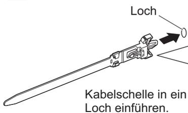
Kabelschelle in ein Loch einführen.
