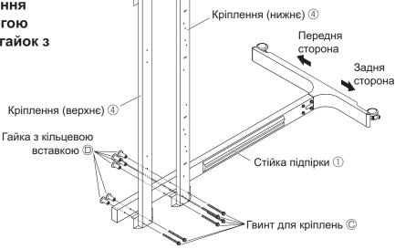
3. Підніміть стійку підпірки й прикріпіть іншу стійку підпірки ① до протилежного боку кріплень за допомогою гвинтів для кріплень © (6) і гайок з кільцевою вставкою © (6).
