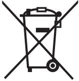
Estos símbolos en los productos, embalajes y/o documentos adjuntos, significan que los aparatos eléctricos y electrónicos y las baterías no deberían ser mezclados con los desechos domésticos.
