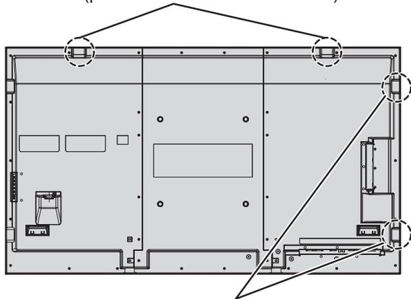
Posiciones de montaje de los cáncamos
