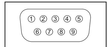
Disposición de contactos para la terminal SERIAL
