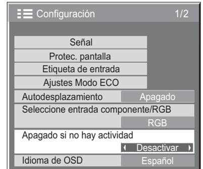
Si esta función está en estado "Activar", la alimentación se desconectará (modo espera) automáticamente si no se realiza ninguna operación en la pantalla durante 4 horas.
