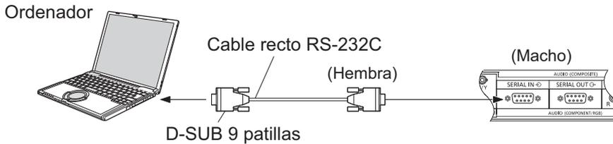
Además, se puede controlar una pantalla LCD concreta con un PC, cuando estén conectadas varias pantallas LCD en cadena tipo margarita.
