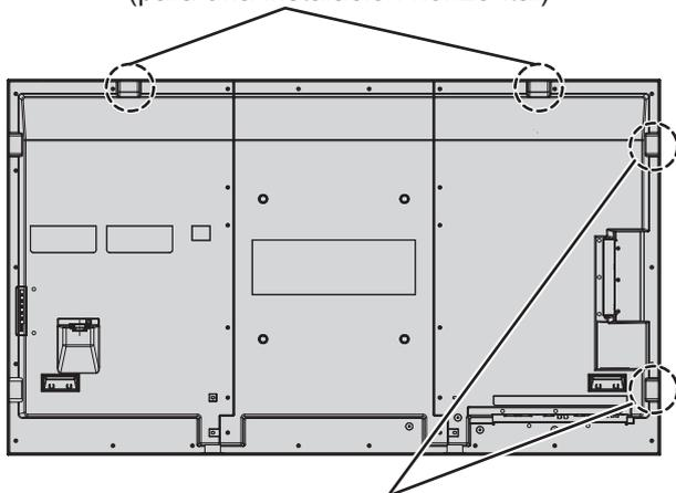
Posiciones de montaje de los cáncamos
