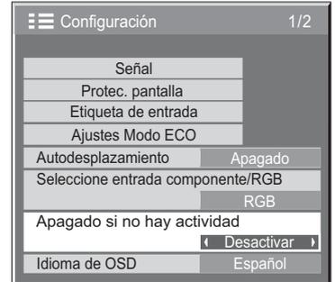
Si esta función está en estado "Activar", la alimentación se desconectará (modo espera) automáticamente si no se realiza ninguna operación en la pantalla durante 4 horas.
