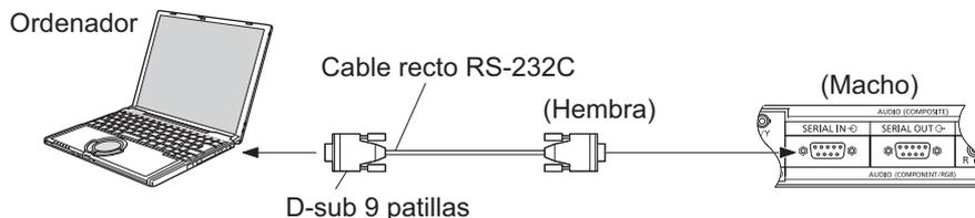
Además, se puede controlar una pantalla LCD concreta con un PC, cuando estén conectadas varias pantallas LCD en cadena tipo margarita.
