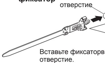
Вставьте фиксатор в отверстие.
