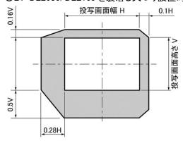
\*ET-DLE055 使用時は光軸シフト機能を使用できません。ET-DLE030 使用時は光軸が固定となります。
