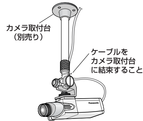
<天井へのカメラ設置例>
