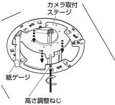
局ご調整ねじ (埋込シャーシの内側) 調整は1か所の高さ調整ねじで 調整できます。 締付トルク: 0.1 N·m {1 kgf·cm} %0.29 N·m {3 kgf·cm} 以上のトルクをかけないでください。破損の原因となります。
