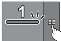
Світлодіодний індикатор допоміжної кнопки ВИМК.
