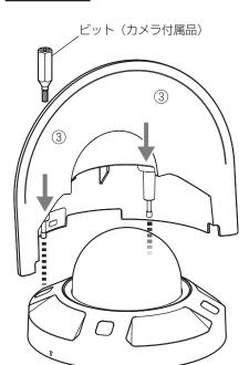
③ 本機をエンクロージャーに仮固定し、本機に装 着されている長いエンクロージャー固定ねじ を時計回りに回転させ、カメラのエンクロー ジャーを貫通させる。
